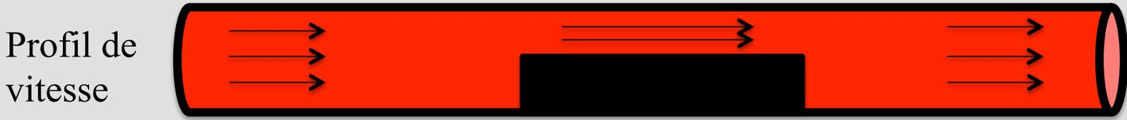
Profil plat, sans perte d'énergie (absence de résistance à l'écoulement)
